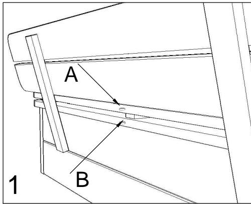
**DK:** For at sikre at låget ikke klapper i, når der sidder børn i sandkassen, skal der monteres en sikring i hver ende.
