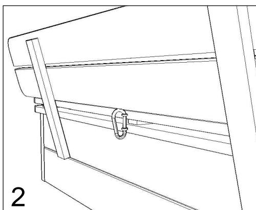
**SE:** För att undvika att locket fälls ned medan det sitter ett barn i sandlådan, ska ett skydd monteras i varje ända
