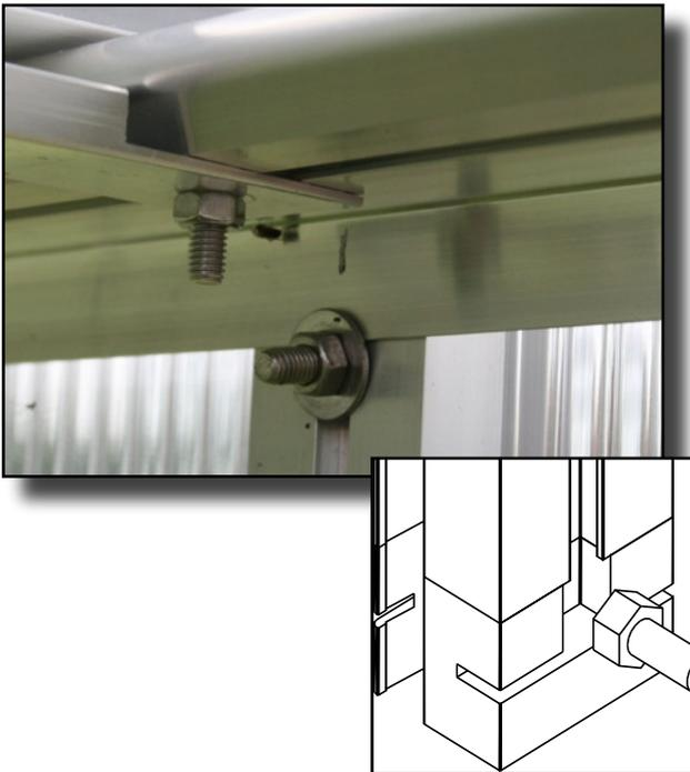
Im Bereich des Kunststoffgleiters zwei Schrauben M6 x 16 (S5) einziehen.
