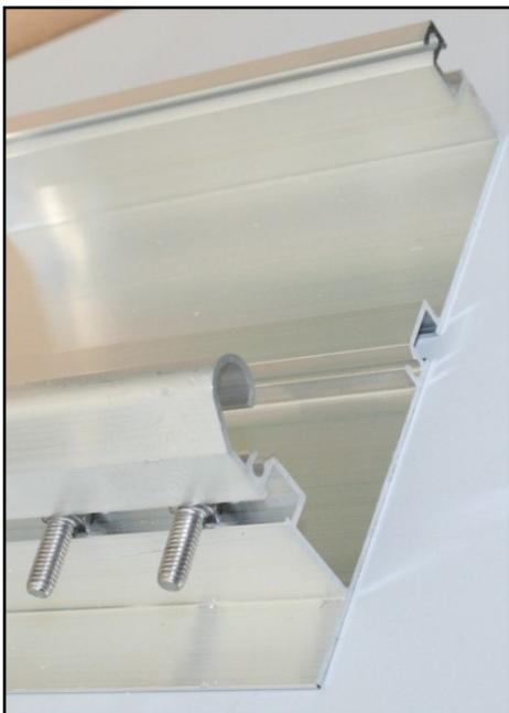
In den Schraubkanal, auf der Unterseite des vorderen Längsprofils (Pos. 1.1) pro Gewächshausprosse eine Schraube M6 x 16 einziehen.
