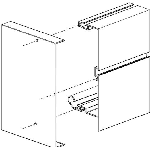
Das Querprofil (Pos. 2) und die Längsprofile (Pos. 1/1.1) durch die vorgebohrten Löcher mit den Linsenkopfschrauben 4,2 x 13 miteinander verschrauben.
