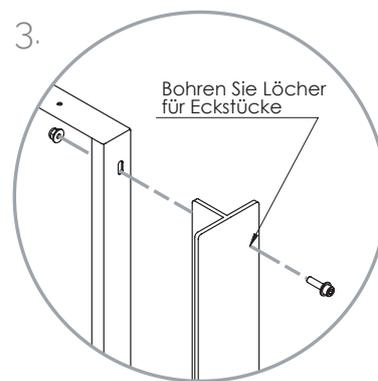
3. Dank der multifunktionalen T-Profile können mit den Paneelen alle Arten von Formen erstellt werden. Dank der langen Verankerungstifte an der Unterseite der T-Profile können die Paneele bodennah installiert werden.
